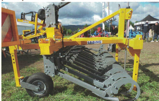
Bineuse Leibing : modèle en 3 m de large, 12 éléments en 25 cm, et montage frontal.
