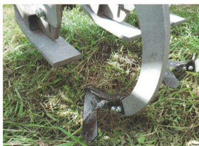
Des patins sont montés en amont des socs sur les éléments de bineuse à faucilles Leibing.
